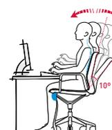
Inclinación del respaldo de 10° y regulación de presión en (5 posiciones)
