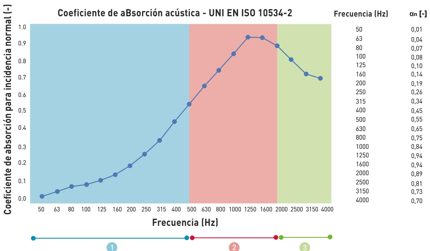
Coeficiente de absorción acústico por incidencia normal calculado en el tubo de Kundt según la norma UNI EN ISO 10534-2, test efectuado por Materiacustica Società spin-off de la Università degli Studi di Ferrara.
