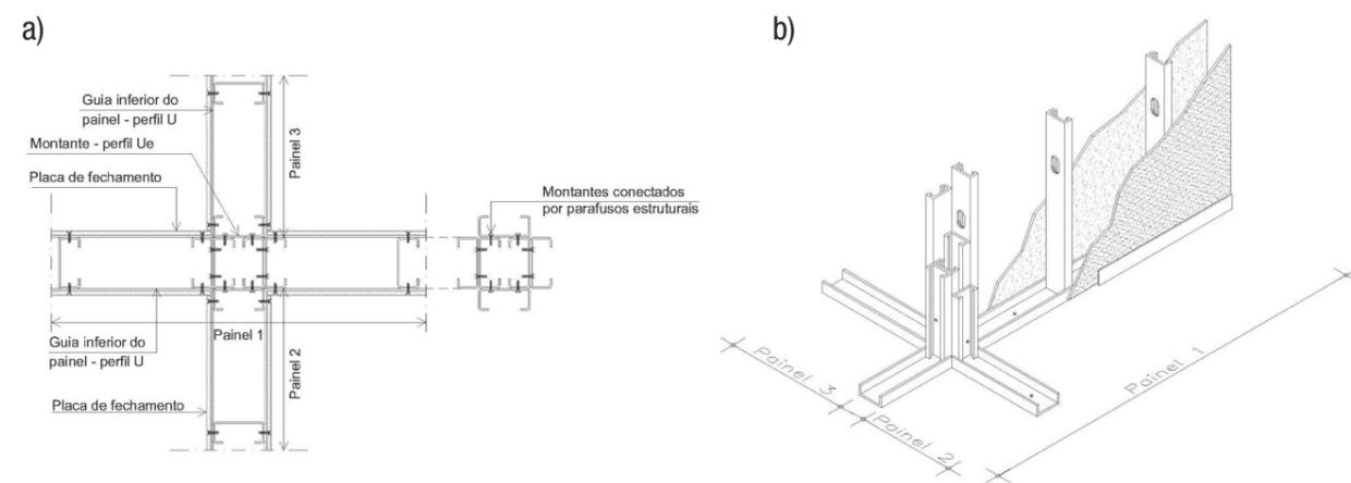
Figura 3.19 - Encontro de três painéis: a) planta b) perspectiva
