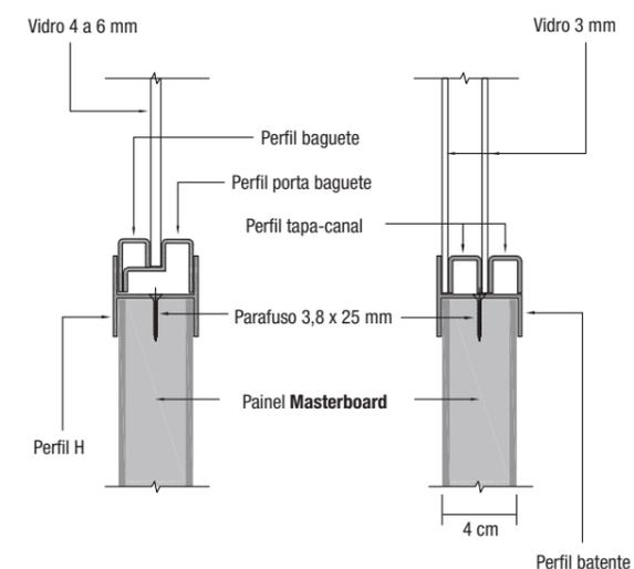
**FIXAÇÃO DE PAINÉIS E ALVENARIA - ARREMATE TOPO**
