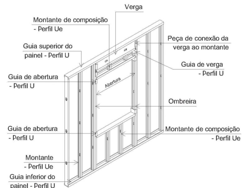
Figura 3.8 - Desenho esquemático de painel estrutural com abertura
