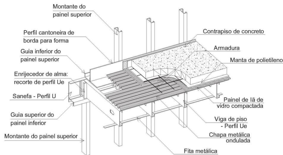
Figura 4.3 - Desenho esquemático de laje úmida
