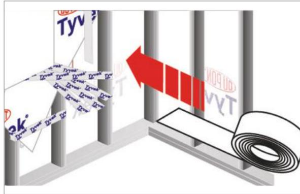
O comprimento dessa fita deve ser suficiente para cobrir os espaços vazios e sobrar pelo menos 3 cm de fita na parte interior da estrutura
