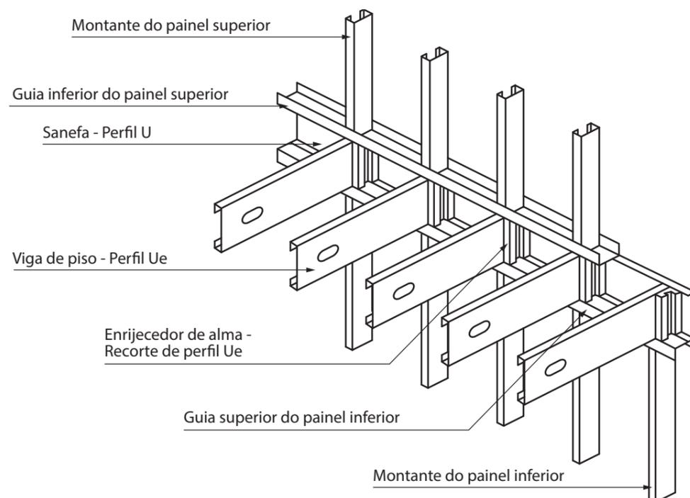
Figura 4.1 - Estrutura de piso em Light Steel Framing
