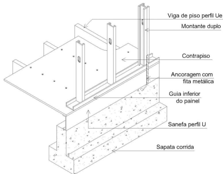
Figura 2.5 - Corte detalhado de fundação tipo sapata corrida
