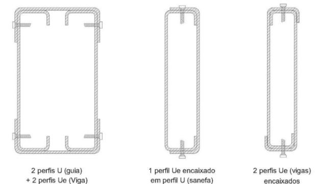
Figura 4.11 - Vigas compostas para aumentar a resistência
