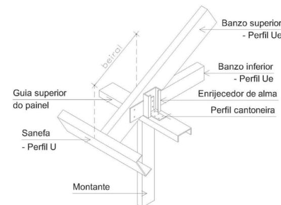
Figura 5.16 - Detalhe de beiral de telhado
