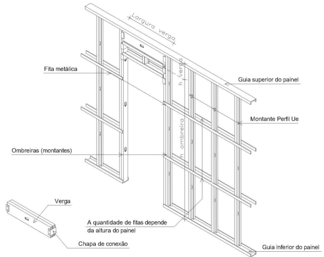
Figura 3.12 - Fita metálica para travamento de painel
