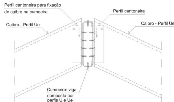
Figura 5.5 - Cumeeira de telhado estruturado com caibros
