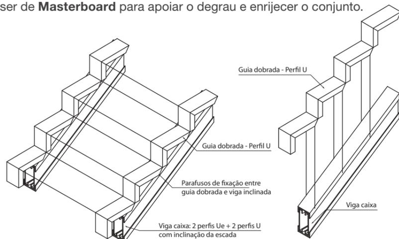
Figura 4.15 - Desenho esquemático de escada viga caixa inclinada
