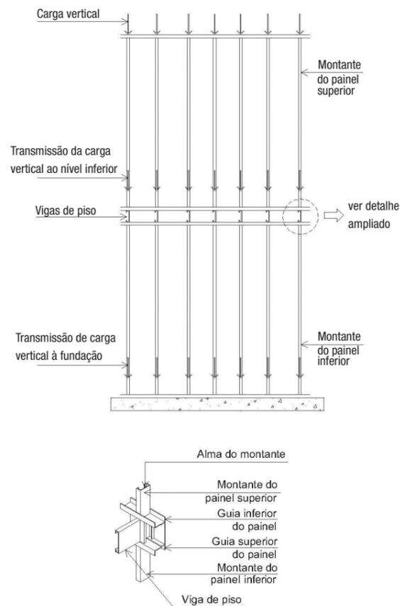
Figura 3.1 - Transmissão da carga vertical à fundação
