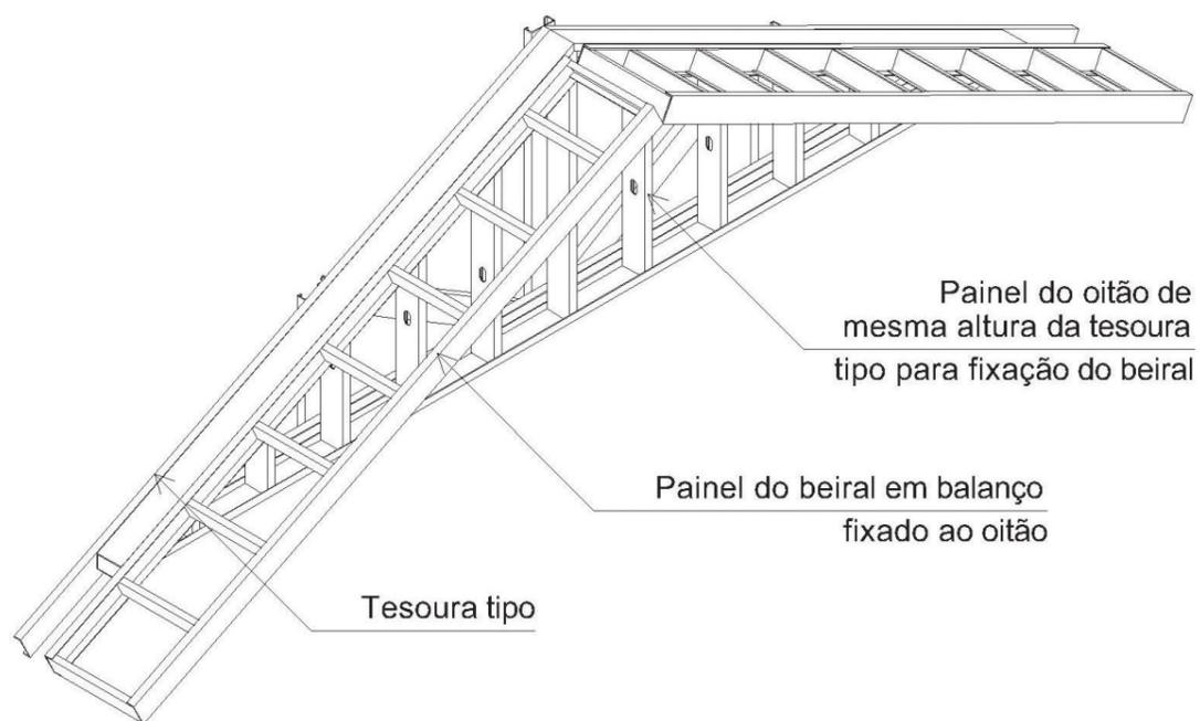
Figura 5.22 - Painel de beiral em balanço
