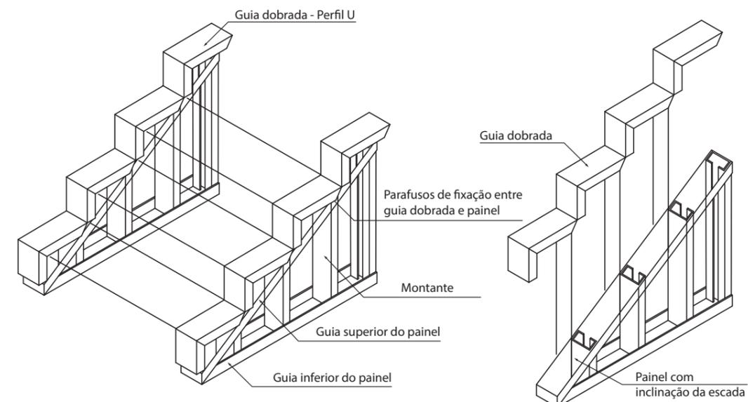
Figura 4.16 - Desenho esquemático de escada painel com inclinação
