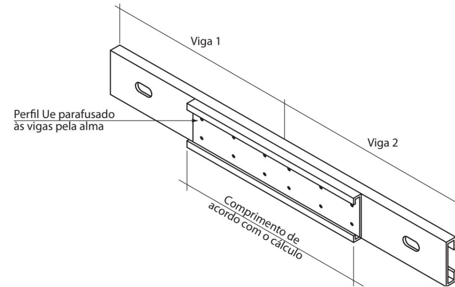
Figura 4.13 - Emenda de viga de piso
