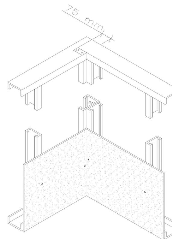
Figura 3.17 - Fixação de painéis de canto
