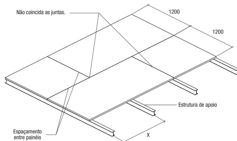
Nota: Para alguns revestimentos, nos vãos entre apoios da estrutura é indicado o uso de bloqueadores ou apoios auxiliares nas bordas do painel.
