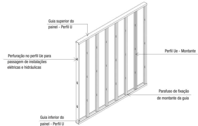
Figura 3.2 - Painel típico em Light Steel Framing
