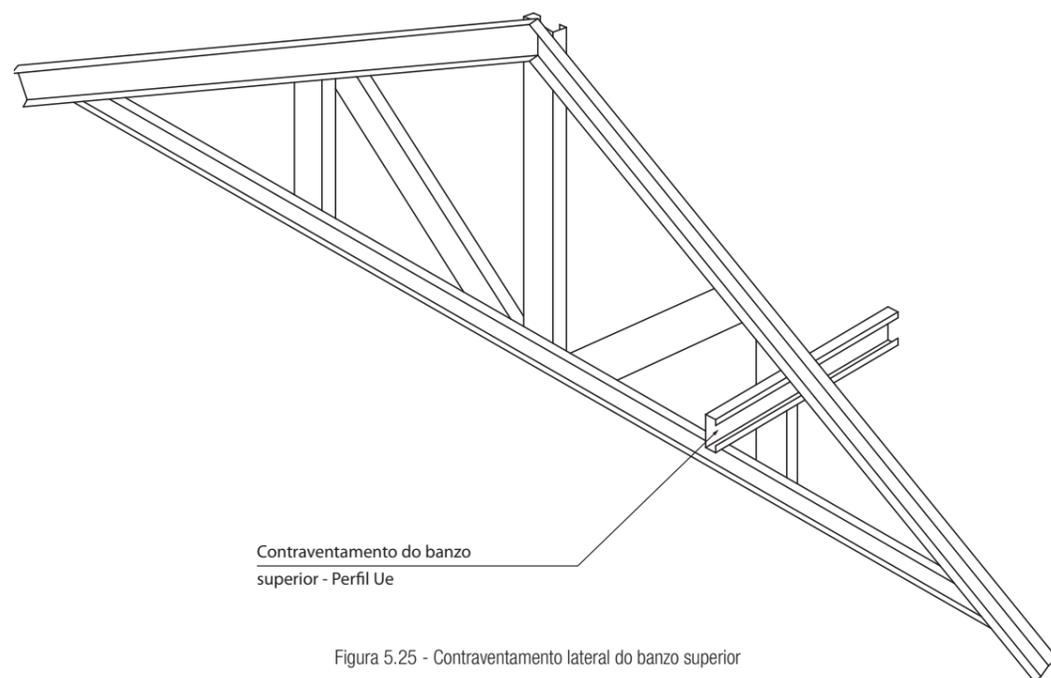
Figura 5.25 - Contraventamento lateral do banzo superior
