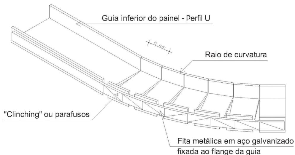
Figura 3.22 - Método para curvatura de perfis U
