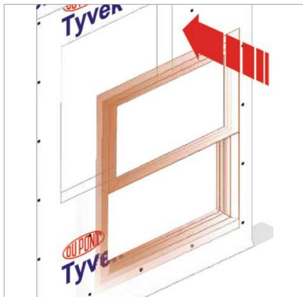
B) Sele ao redor das janelas, tanto na parte interior quanto exterior da estrutura utilizando Selamax.
