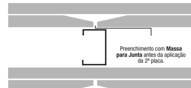
As **Placas Cimentícias** devem ser aplicadas encostadas no teto para facilitar o tratamento posterior da junta e devem ter folga de 10 mm em relação ao piso para evitar a absorção de umidade por capilaridade.
