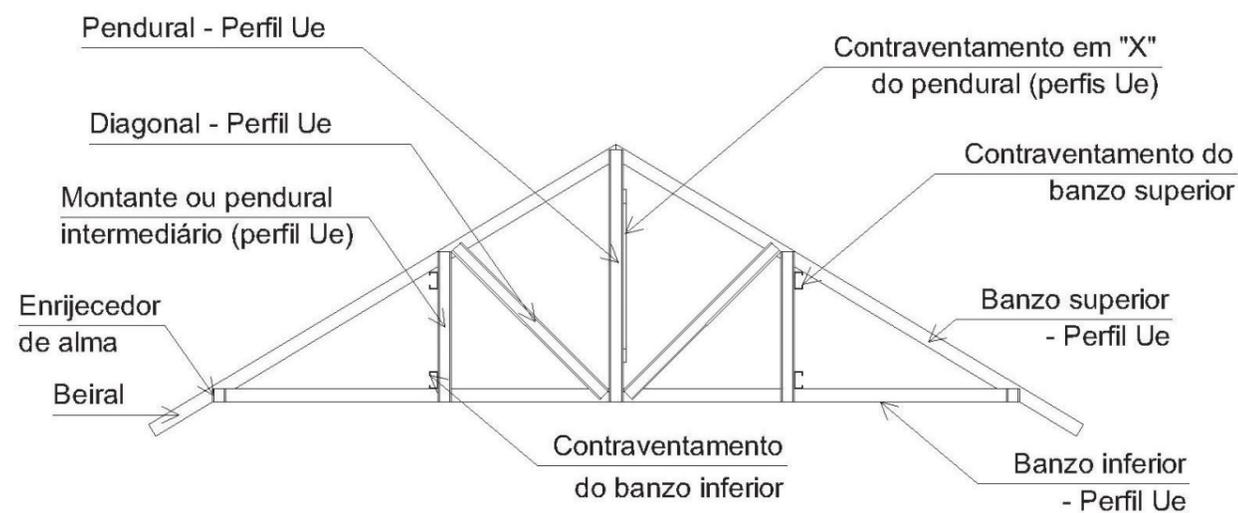
Figura 5.14 - Elementos de uma tesoura
