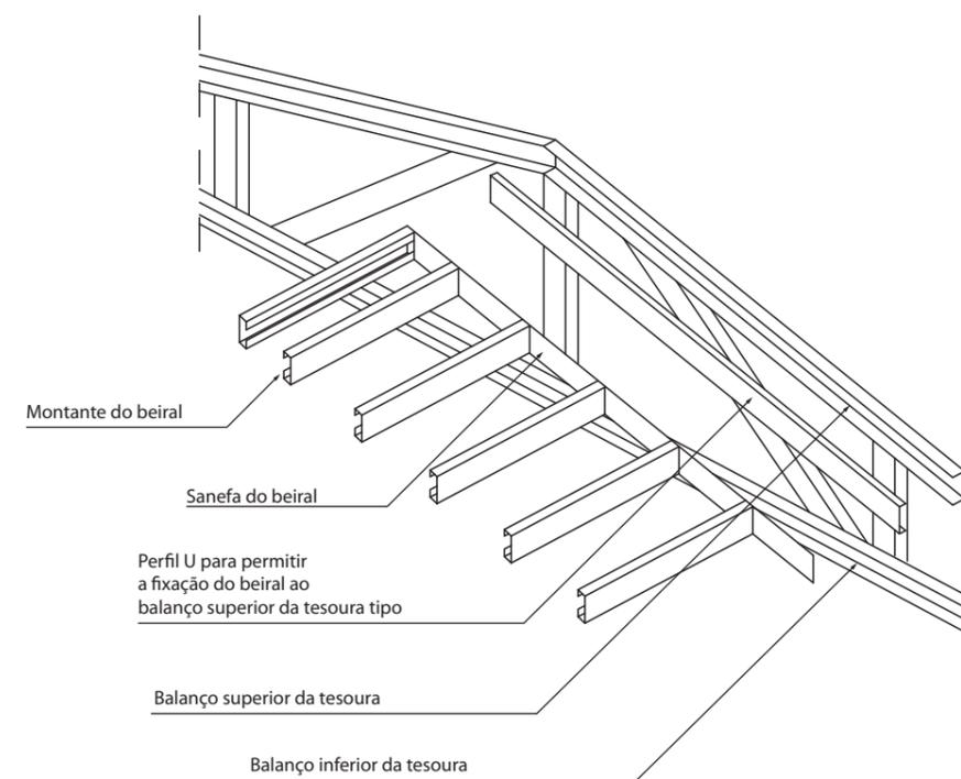
Figura 5.21 - Detalhe de fixação de painel de beiral
