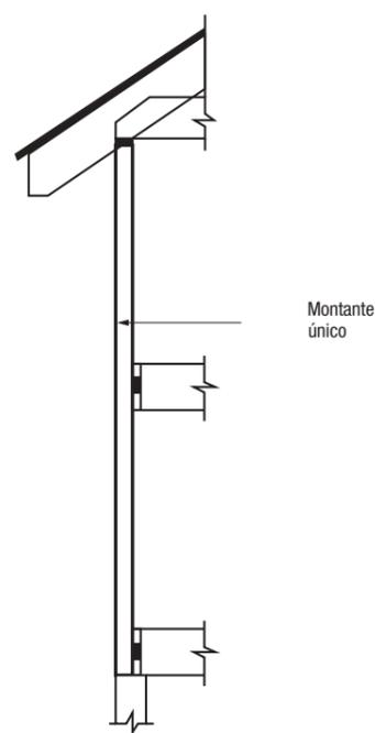
Figura 2.3 - Esquema de construção tipo “balloon” (Fonte: SCI)
