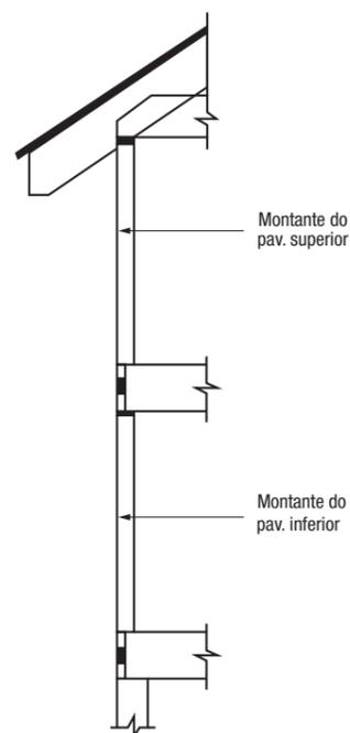
Figura 2.2 - Esquema de construção tipo “platform” (Fonte: SCI)
