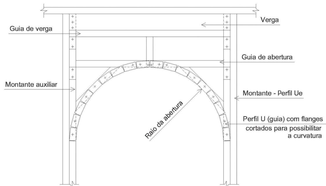
Figura 3.23 - Método para construção de aberturas em arco
