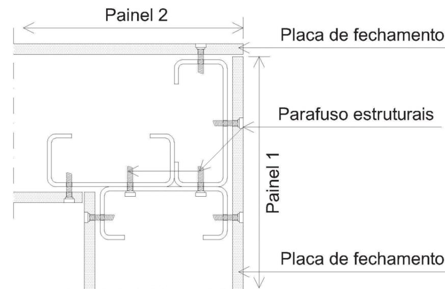
Figura 3.16 - União de três montantes
