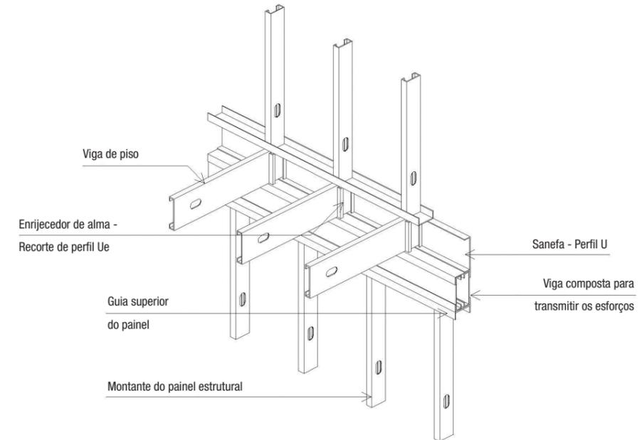
Figura 4.10 - Viga de distribuição da carga do piso para os montantes
