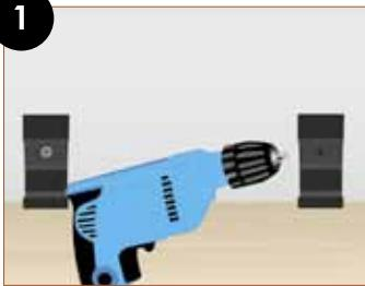
Fije el clip al muro con tornillos, a una distancia máxima de 30 cm. entre cada clip. Se utilizan 8 unidades cada 2,5 metros.
