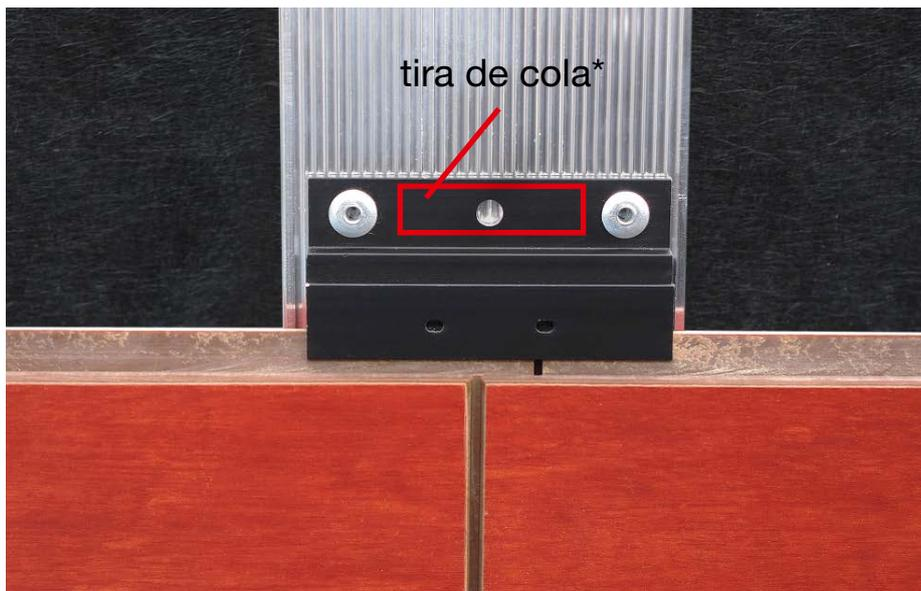
Por supuesto, Modulo también se puede montar con una subestructura de aluminio. Para este tipo de montaje se deben utilizar 2 remaches ciegos (5 x 10 mm con una cabeza máx. K14) por placa de sujeción si el grosor del material de la subestructura es de entre 1,5 y 3 mm (longitud máx. 2800 mm).
