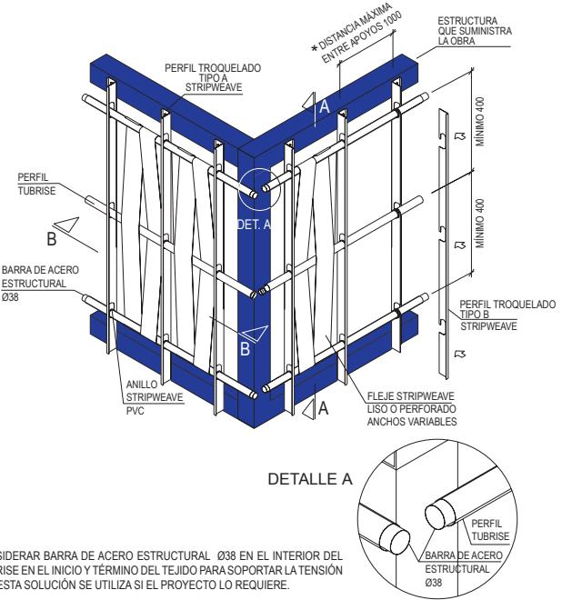
NOTA: CONSIDERAR BARRA DE ACERO ESTRUCTURAL Ø38 EN EL INTERIOR DEL PERFIL TUBRÍSE EN EL INICIO Y TÉRMINO DEL TEJIDO PARA SOPORTAR LA TENSIÓN DEL FLEJE. ESTA SOLUCIÓN SE UTILIZA SI EL PROYECTO LO REQUIERE.
