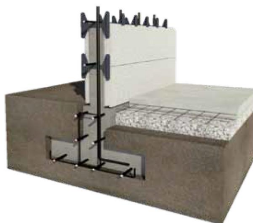
Anclaje a cimentación según proyecto
